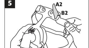
Faites passer la courroie supérieure A2 du harnais à travers la fente B2 sur le masque, en vous assurant que le velcro est tourné vers l'extérieur.
