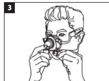
Fixez la boucle des courroies inférieures du harnais dans le cadre du masque
